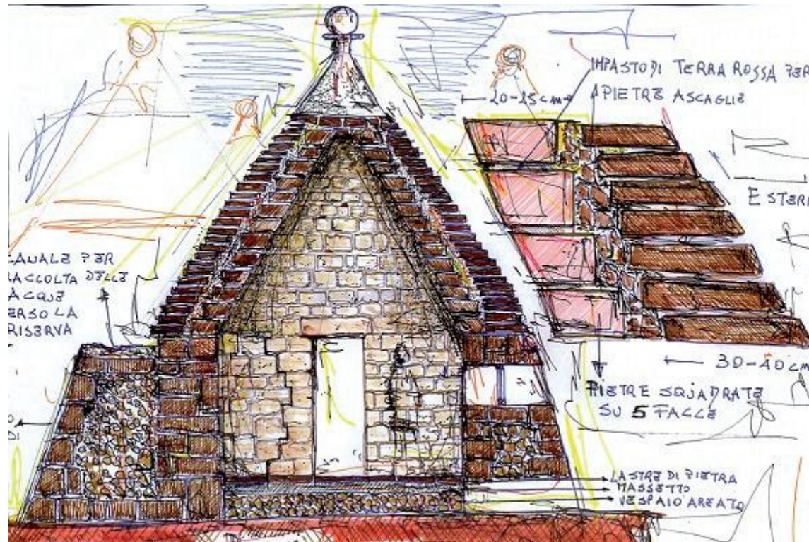
Les trulli, habitats typiques de la région des Pouilles (Italie) sont des dômes construits en encorbellement.
