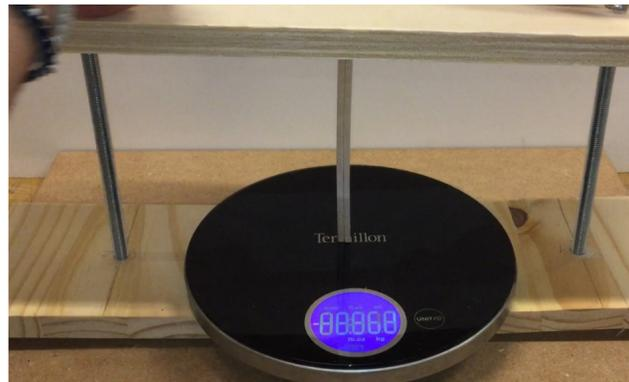
Tests sur les trois sections : en «H», circulaire et carrée (de droite à gauche)
