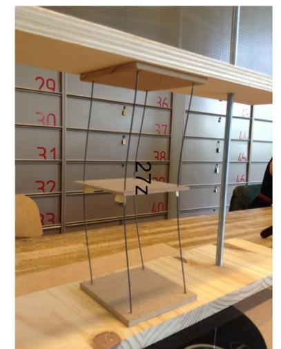
Nous pouvons constater que la maquette sans plancher intermédiaire flambe plus rapidement que la maquette avec plancher intermédiaire ; soit 3kg pour la première et 6kg pour la seconde.
